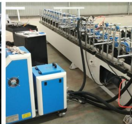
木条包覆应用 Wood strip coating application
