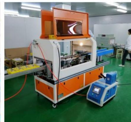
全自动高速封盒机 Automatic high speed box sealing machine
